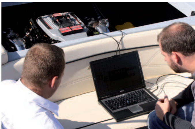
Einstellungssache: Das Steuergerät wird auf den Motor und die Wünsche des Eigners eingestellt.
