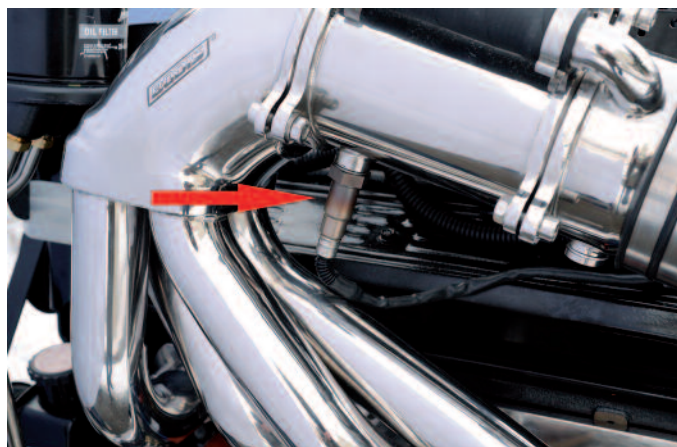
Die Lambdasonde (Pfeil) misst den Sauerstoffgehalt im Abgas.
