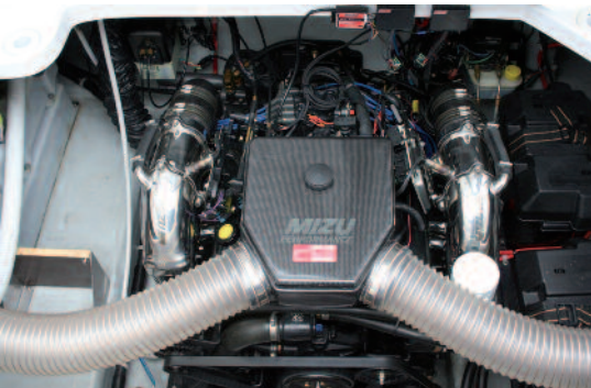
Oben: Eine Airbox ermöglicht die ungehinderte Zufuhr der Verbrennungsluft und sorgt für „freien Atem“.
