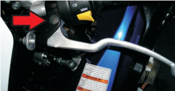
Entfernen Sie die originale Befestigungsschraube indem Sie die Mutter an der Unterseite abdrehen und anschließend die Schraube herausdrehen.
