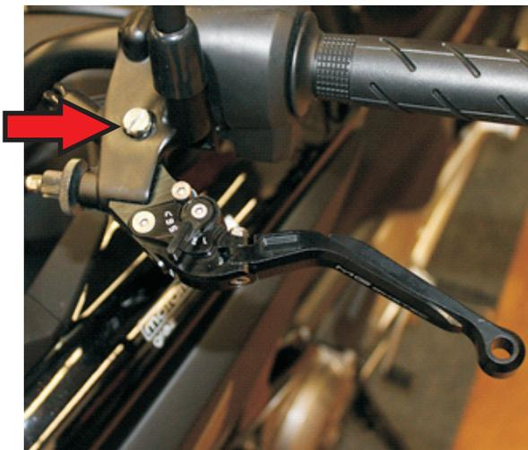
Kupplungsseil in den MIZU-Hebel einhängen. Mit etwas Fett und der originalen Schraube und Mutter mit 6 Nm festschrauben.
