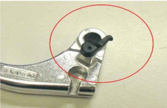
Originale Lagerbuchse aus dem Hebel entnehmen und in den MIZU-Hebel mit etwas Fett einsetzen.
