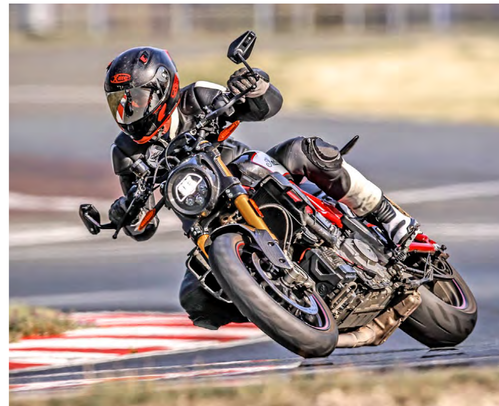
Zwar blieb das Fahrwerk serienmäßig, Fahrwerks-Guru Daniel Stiefel stellte es für mehr Schräglagenfreiheit ein: Federbasis hinten hoch, und Gabeldämpfung leicht verändert
