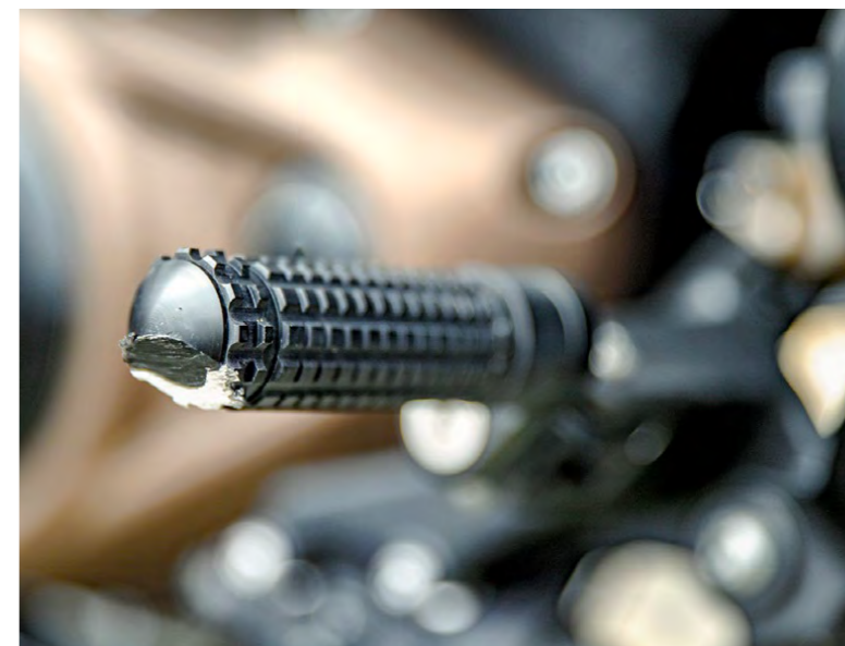
Happy Rastenschleifung in Oschersleben. Vor allem die Harley ließ Material. Nach der Raste kommt der Seitenänder, bei der Indian der Auspuff
