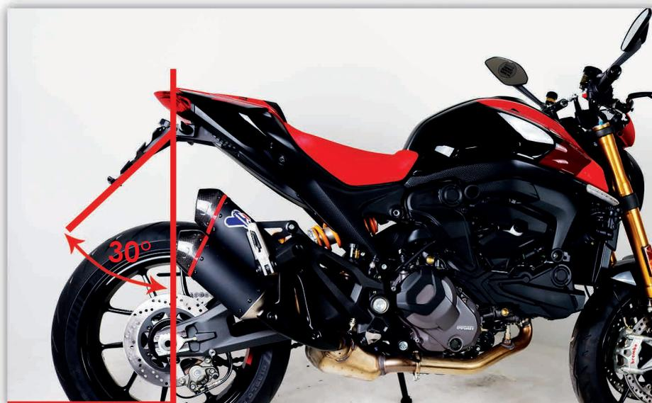
Richten Sie den Kennzeichenhalter so am Fahrzeug aus (Schraube A), dass er symmetrisch am Fahrzeug sitzt und vom Winkel den gesetzlichen Anforderungen von 30° entspricht (siehe Bild oben).
