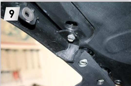
Kennzeichenträger an Grundhalterung schrauben, Blinkerhalter mit Buchsen verbinden. Bei der Montage mit Kunststoffabdeckung werden unten 2 x M6 originale Schrauben verwendet. Nach Abschluss der Montage die Funktion der Blinker und Beleuchtung prüfen. Auf korrekte Gradzahl (30°) vom Halter achten.
