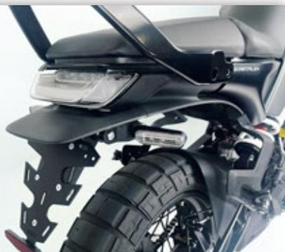
MIZU Kennzeichenhalter mit den 4 x M6 Schrauben und vier Unterlegscheiben links und rechts an den originalen Befestigungspunkten am Fahrzeug anschrauben. Kabel für Blinker und Kennzeichenbeleuchtung einführen, diese können mit den zwei Kabelbindern an den Bohrungen fixiert werden. Der Kennzeichenhalter kann mit oder ohne der originalen Kunststoffabdeckung oben montiert werden.
