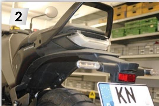
2 Heckverkleidung demontieren.
