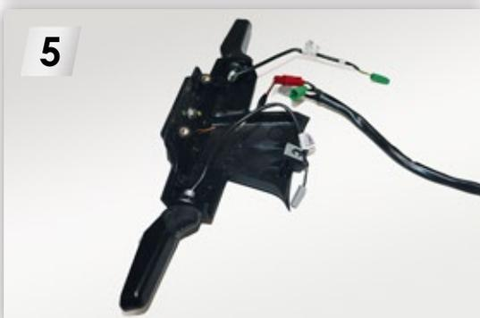
5 Die originalen Blinker demontieren.
