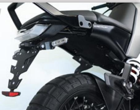
Abschließend Nummernschild und Rückstrahler montieren.
