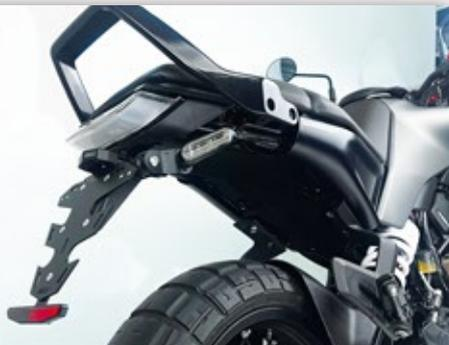
Die originalen Blinker montieren. Rechts — grau, links — grün. Hauptkabel wird wieder verwendet.
